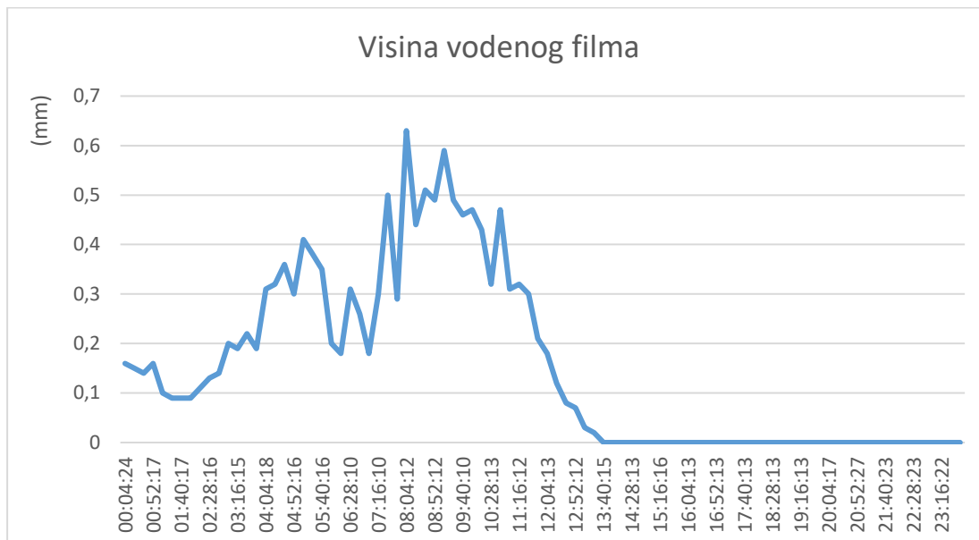
Graf 3. Prikaz trenutnih temperatura zraka i temperatura kolnika, te visina vodenog filma za dan 15.5.2016. kod digitalne mjerne stanice Kupljenovo Kolnik apsorbira Sunčevo zračenje i pretvara u toplinu, a višak reflektira. Vodeni film apsorbira dio energije pa je razlika u temperaturi kolnika i zraka vrlo mala. Smanjenjem vodenog filma, razlika u temperaturi kolnika i zraka se povećava.
