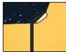
Slika 3. Nepravilno postavljeno rasvjetno tijelo
